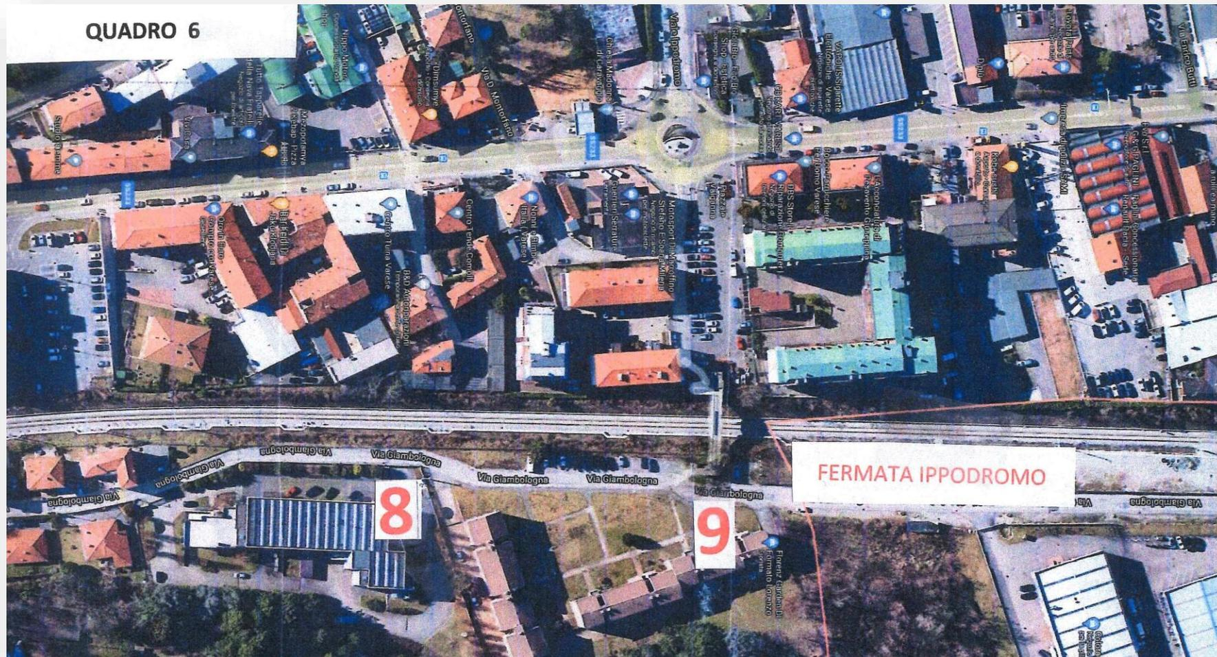
In questa tratta si prevede la realizzazione di una nuova fermata ferroviaria (VARESE Ippodromo) mediante l'allargamento dell'esistente trincea in cui corre il sedime ferroviario.
